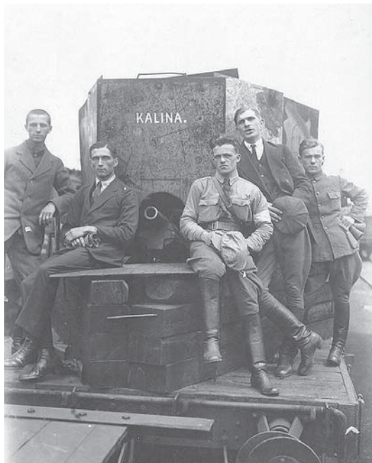
11. Wagon artyleryjski pociągu pancernego „Pieron”. Dobrze widoczna lufa francuskiej armaty górskiej wz. 1906 oraz opancerzenie zbudowane ze stalowych płyt i podkładów kolejowych (ze zbiorów Narodowego Archiwum Cyfrowego w Warszawie)
